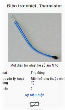
a) Cảm biến nhiệt điện trở
